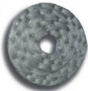
Disque laine d'inox tressé diamètre 432mm de qualité supérieure : bonne tenue de la laine sur le disque. Idéal pour la cristallisation chimique des sols en marbre, pierre, béton, granit et terrazo. Utilisable à 140 ou 350 tours minutes avec un rendement de 75 m<sup>2</sup>/h.
