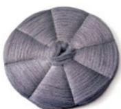
Disque laine acier diamètre 432mm. Idéal pour la cristallisation chimique des sols en marbre, pierre, béton, granit et terrazo. Utilisable à 140 tours minutes avec un rendement de 75 m<sup>2</sup>/h.
